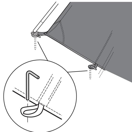
**10** Recouvrez le double-toit sur la tente. Attachez-les à l'aide des boucles situées au bas de chaque coin.
