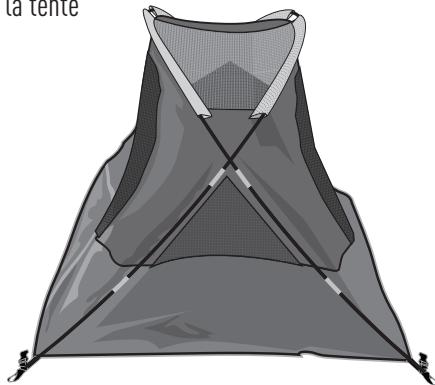
**6** Insérez le mât gris dans le manchon de mât en filet jaune situé sur le toit de la tente.
