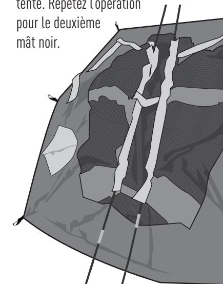
**5** Insérez une extrémité du mât noir dans l'œillet situé dans le coin opposé de la tente. Allez à l'extrémité opposée de la perche et appliquez progressivement une pression sur la perche, en formant un arc jusqu'à ce que vous puissiez insérer l'autre extrémité dans l'œillet. Répétez l'opération pour le deuxième mât. Les deux piquets noirs doivent se croiser à l'avant et à l'arrière de la tente
