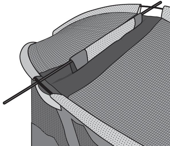
**7** Insérez une extrémité du mât gris dans l'œillet situé sur le côté de la tente. Passez à l'extrémité opposée de la perche et appliquez progressivement une pression jusqu'à ce que vous puissiez insérer l'autre extrémité dans l'œillet. Le mât gris doit maintenant être placé sous les deux mâts noirs.
