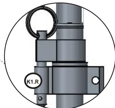
**NOTA: ES OBLIGATORIO** montar K1 de manera que K1-L y K1-R queden montados en la parte INTERIOR de K1 (fig. 1).
